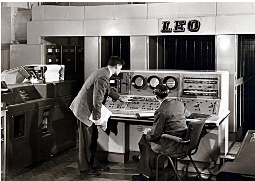
Il design di LEO II fu derivato da quello di LEO I, ma con alcuni cambiamenti basati sull'esperienza acquisita. La microprogrammazione, sviluppata da Wilkes a Cambridge, fu introdotta per la prima volta in LEO II. I tubi di mercurio di LEO II erano lunghi un quarto rispetto a quelli di LEO I, con il fine di rendere il computer operativamente più veloce.
