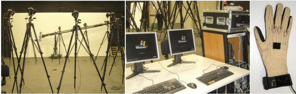
**Figura 3 - Dispositivi di motion capture utilizzati: Vicon e Cyberglove II**
