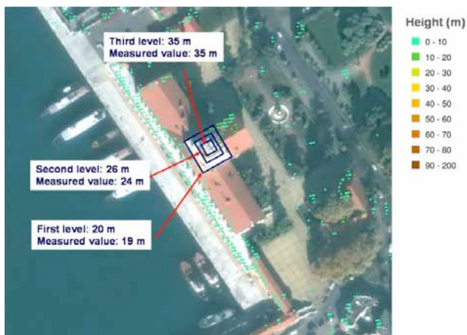
Figura 7 Dati COSMO-SkyMed: stima dell'altezza dell'edificio (Elaborazione e-Geos)
